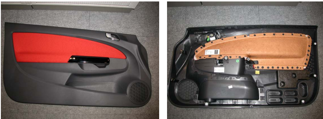
Bild 1: Aufbau der Türverkleidung des Opel Corsa
