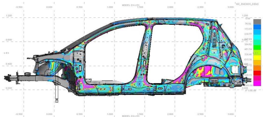
Bild 5: Torsionssteifigkeit des finalen SuperLIGHT-CAR Konzepts
