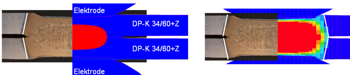
Bild 12: Fügeprozesssimulation: Schweißlinsengeometrie (links) und Gefügeverteilung (rechts)
