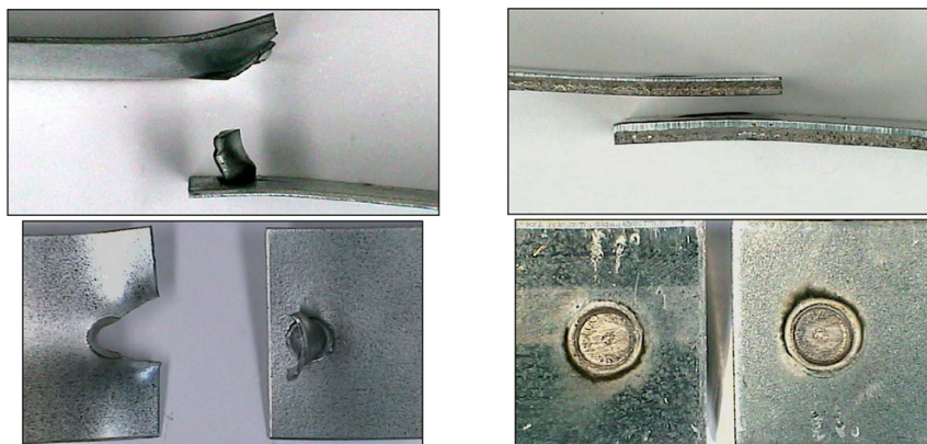
Bild 3: Ausknöpfbuch (links) und Scherbruch (rechts)
