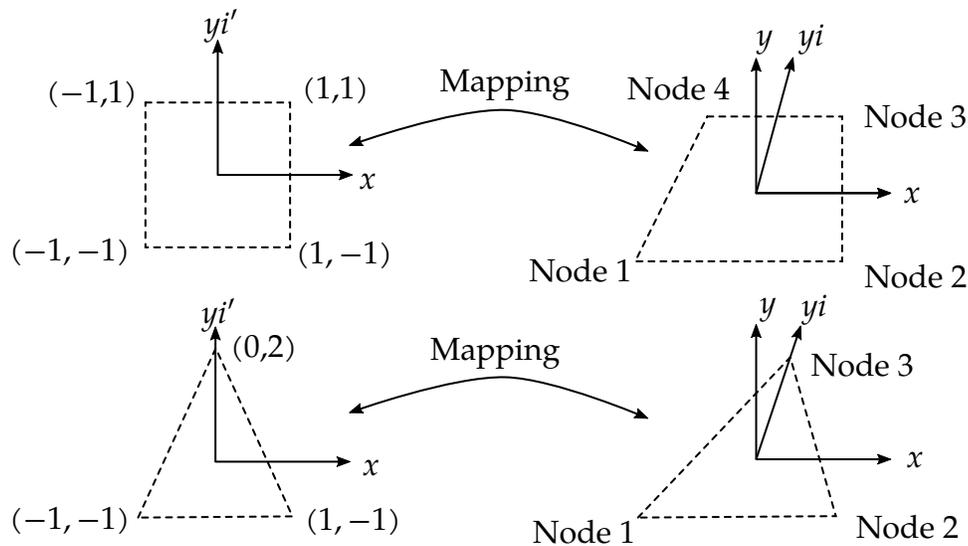
**Figure 4-1.** Isoparametric mapping if GLOBAL = 1
