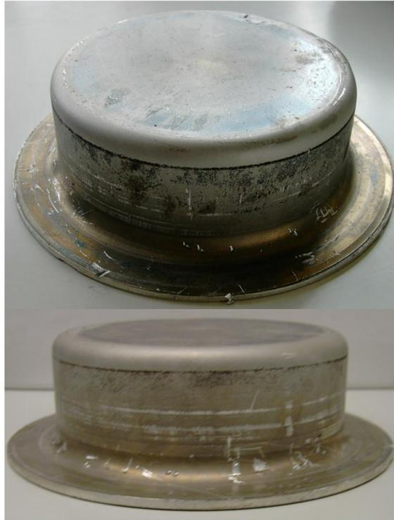
*Bild 3: Endgeometrie der Voruntersuchungen des thermische Hydroformings*
