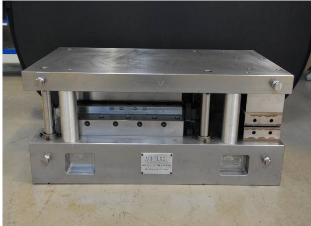
Bild 7: Versuchswerkzeug zur Wärmebehandlung von Flachproben
