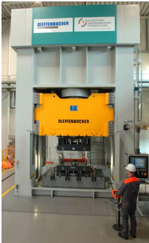
Bild 6: Hydraulische Tryout-Pressen und Ofen bei der SZMF
