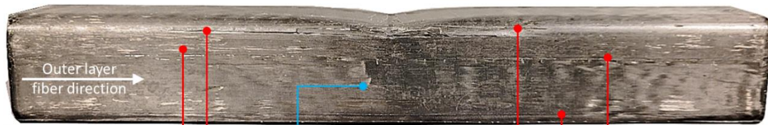
Longitudinal (fiber) tensile & compressive failure (MAT54 HV1&2)
